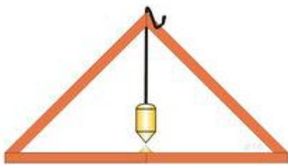
Prinzip der antiken Setzwaage
